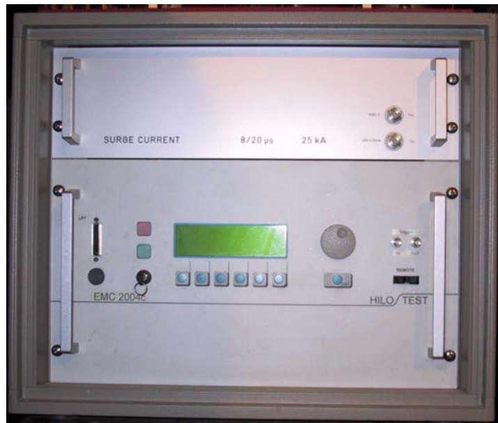
Σχήμα Π1.1: Η γεννήτρια κρουστικών ρευμάτων EMC 2004 της HILO TEST
