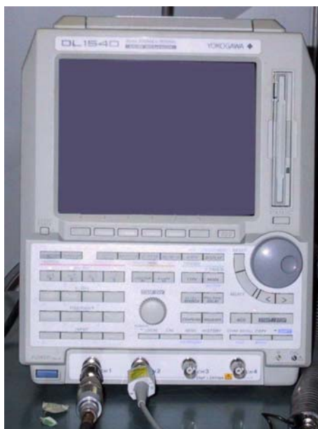
Σχήμα Π1.2: Ψηφιακός παλμογράφος DL 1540 της εταιρείας YOKOGAWA
